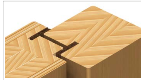
Detail - zwei Dichtungsebenen
