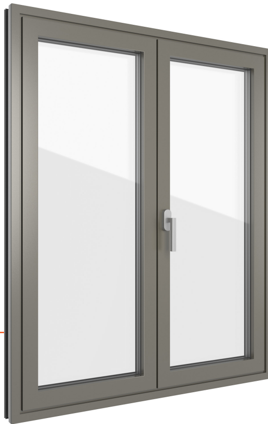
Abbildung in zweiflügliger Ausführung mit glasüberdeckendem Stulp-Profil Nova und raumseitig flächenbündigem Blendrahmen und Flügel, außen und innen Aluminium Classic 805, Randemaillierungsfarbe Schwarz G01
